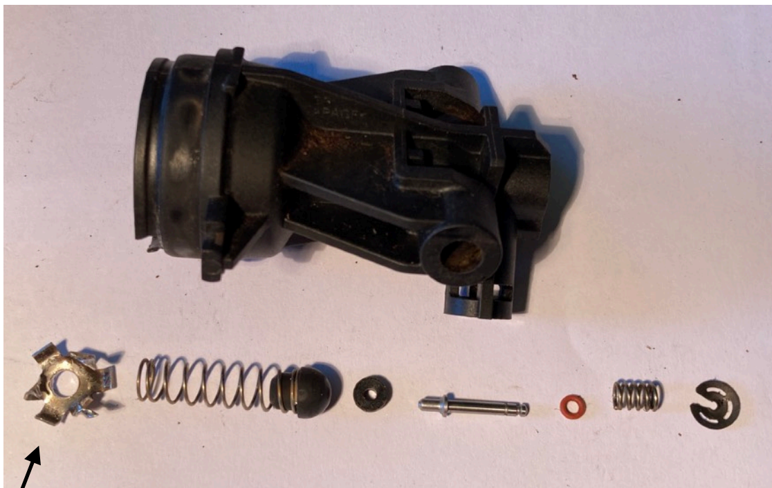
De doorprikker was niet goedschiks te demonteren om de klep te bereiken.
